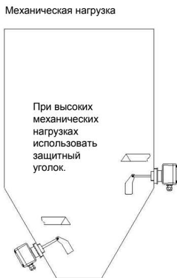
Исполнение с удлинением предназначено только для сигнализации верхнего предельного уровня
