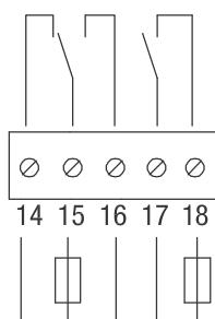
Предохранитель: макс. 2A
