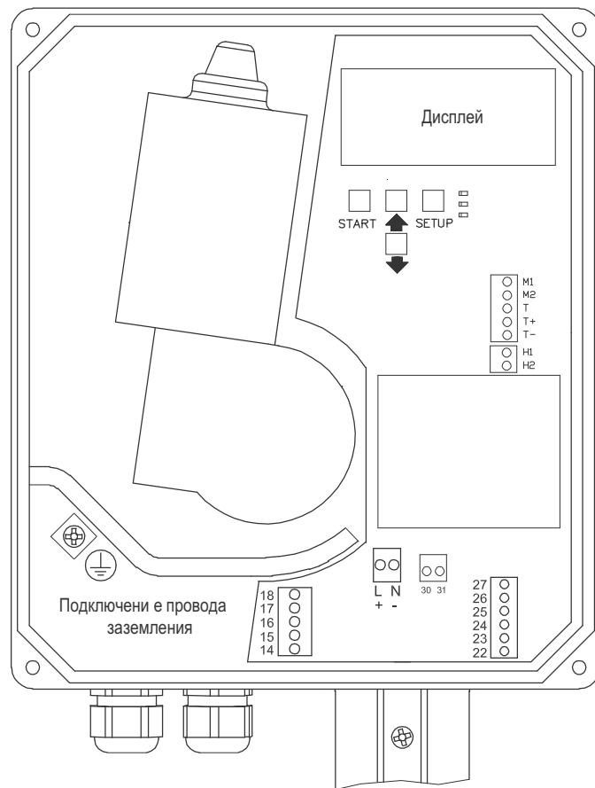
Внутренние клеммы для мотора и отопления
